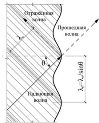
Рис. 2. Явление волнового совпадения: след падающей на пластину звуковой волны, с длиной \lambda_\alpha , равен длине свободной волны изгиба, \lambda_{f1} , в пластине.
